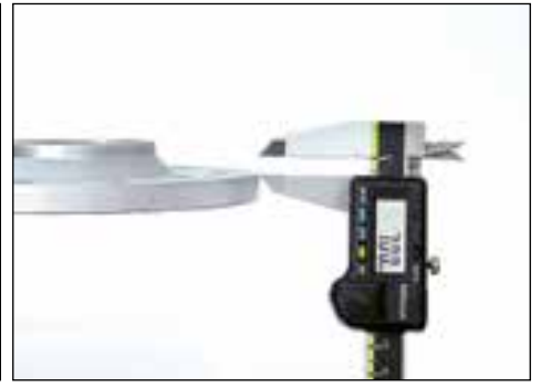
Darstellung Aussenfase 7x45° / Outer bevel 7x45°
